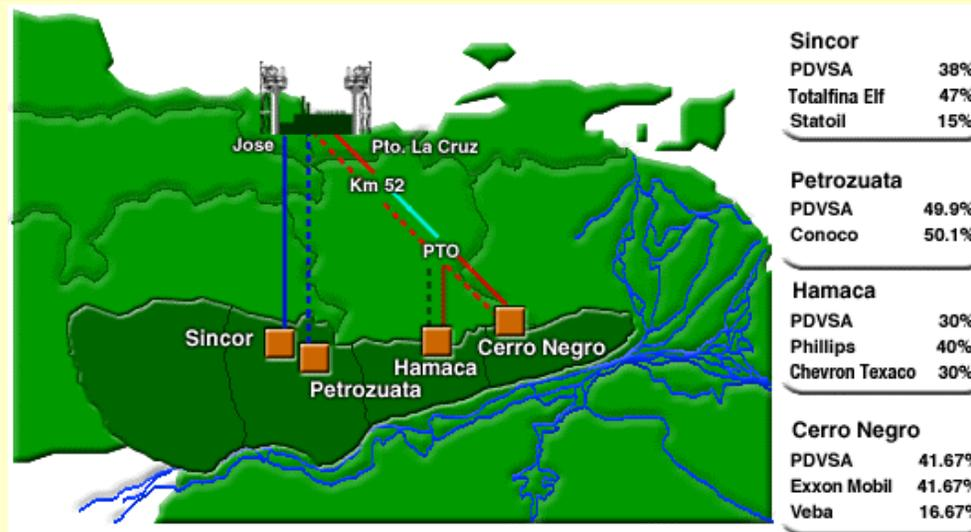
TotalのSincorプロジェクトのみがAPI 8.5度をAPI 32度までアップグレードし、一般向けに輸出している。他のプロジェクトは参加会社の製油所で引取り、改めて精製処理を行なうことが前提となっている。従ってアップグレードの程度は受入先の製油所の装置構成によって決定されており、合成原油のAPI比重、硫黄分などはプロジェクトごとにさまざまである。
