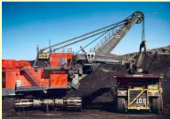
オイルサンドは粘度が高く油層状態で流動しない半固体状の原油であることから、地表から50m程度の深度に存在するオイルサンドは、表土を剥いで露出させたオイルサンド層を砂ごと地表に取り出し、熱水で油分を分離する方法(露天掘り)が採られる。
