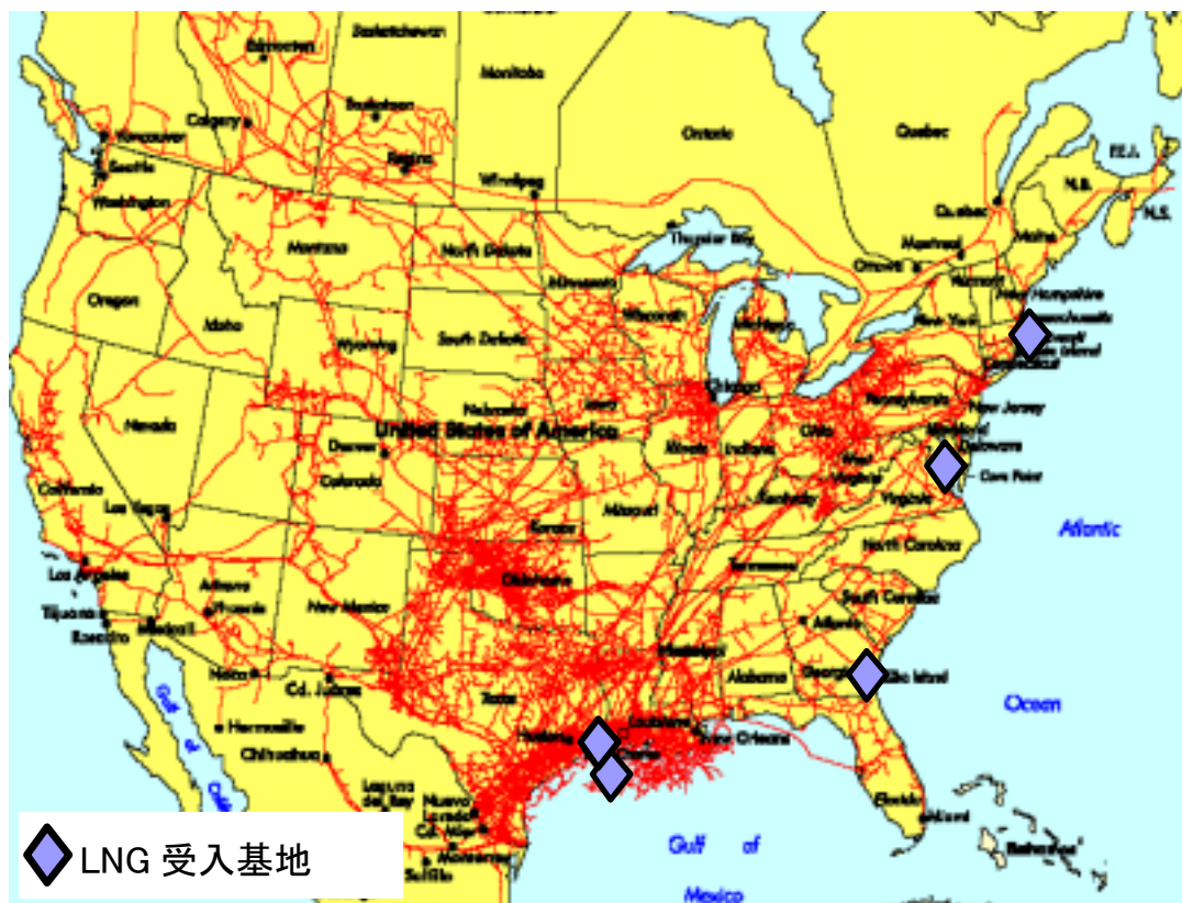
図表 3-3-1 北米の天然ガスパイプラインと既存 LNG 受入基地
