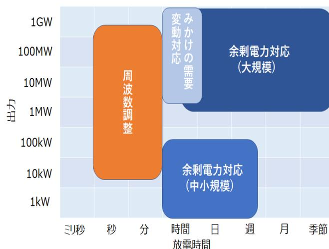
図8 各用途に必要な出力・放電時間
