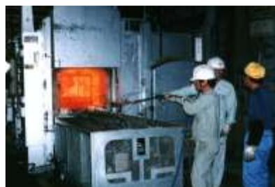
炉内温度分布を計測
