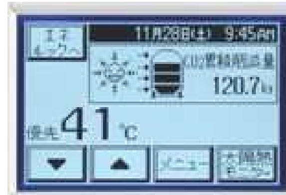
集熱状況、貯湯量、CO<sub>2</sub>削減量
