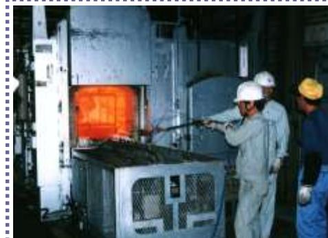
炉内温度分布を計測
