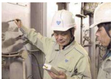
炉壁の温度を計測
