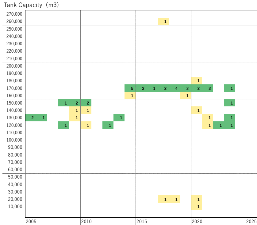
図4 FSRU の容量別竣工数 (2005-2023)
