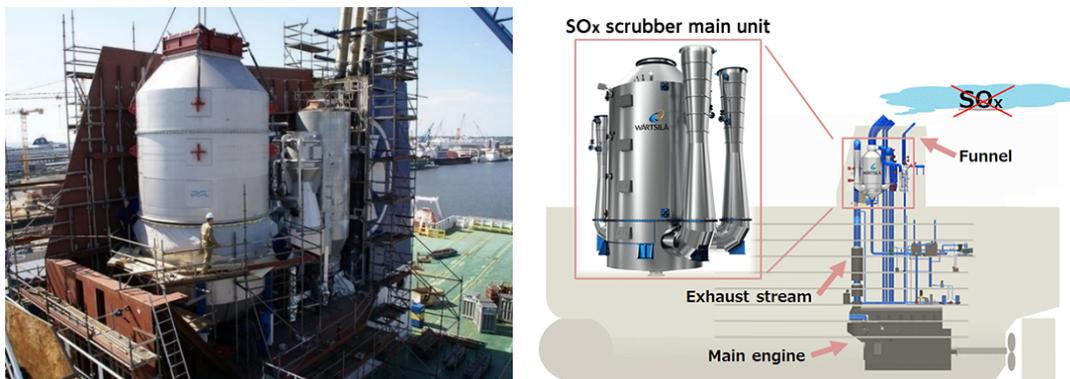
図18 スクラバー装置イメージ
