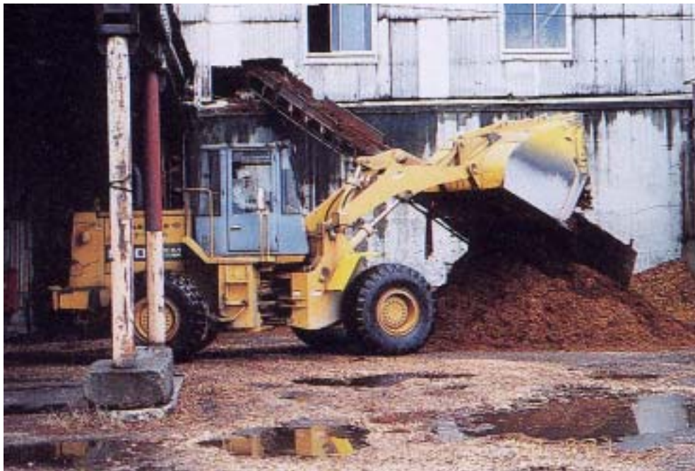
写真 2.4 リフトによって製造ラインに投入される杉樹皮
