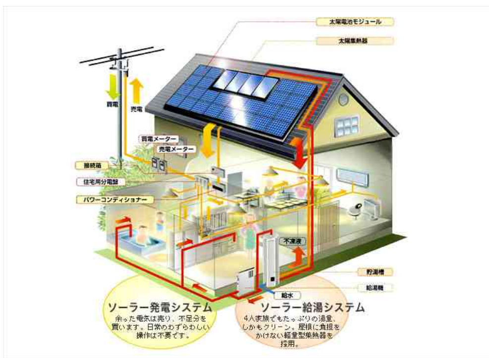
図3.3.5 ハイブリッドソーラーシステム(太陽熱と太陽光を並べて設置したタイプ)
